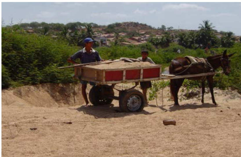
Figura 40: Retirada de areia na época de estiagem com a diminuição do fluxo hídrico, passado o período chuvoso, surgem os bancos de areia no leito do rio. Parte deste material é retirada para uso na construção civil.
