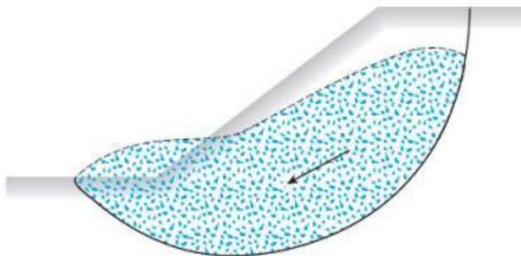
Figura 6 - Instabilidade de taludes por deslizamento
