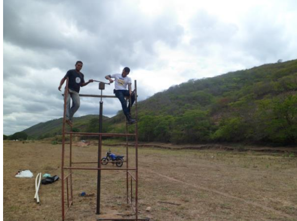
Figura 8. Inserção do tubo de ferro com piezômetro no solo.
