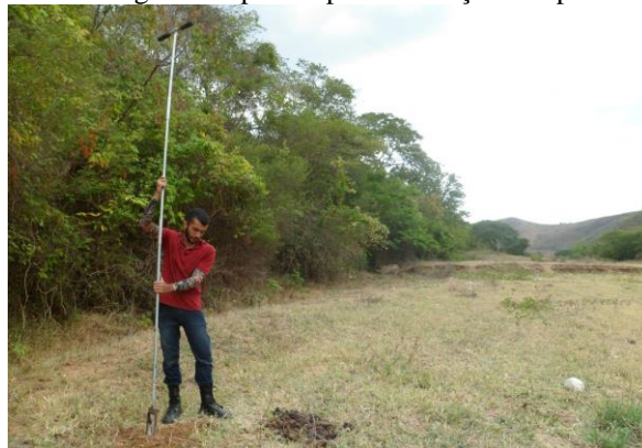
Figura 7. Tradagem dos pontos para instalação dos piezômetros.
