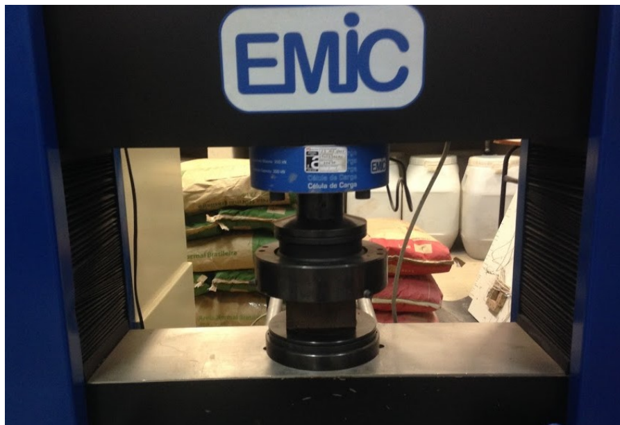
Figura 10 - Ensaio de resistência à compressão bloco
